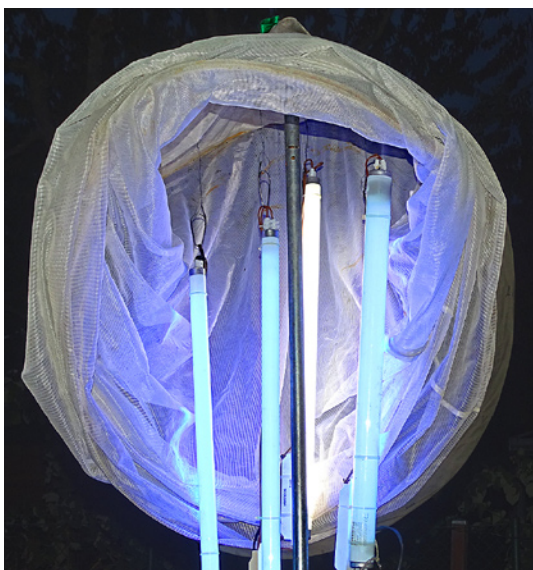
Abb. 1: Digitale Vorschaltgeräte direkt an die Röhren montiert.
